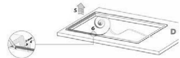
**E** Außenkontur-Markierung der Spüle auf der Arbeitsplatte entfernen, Spülenrand reinigen.
