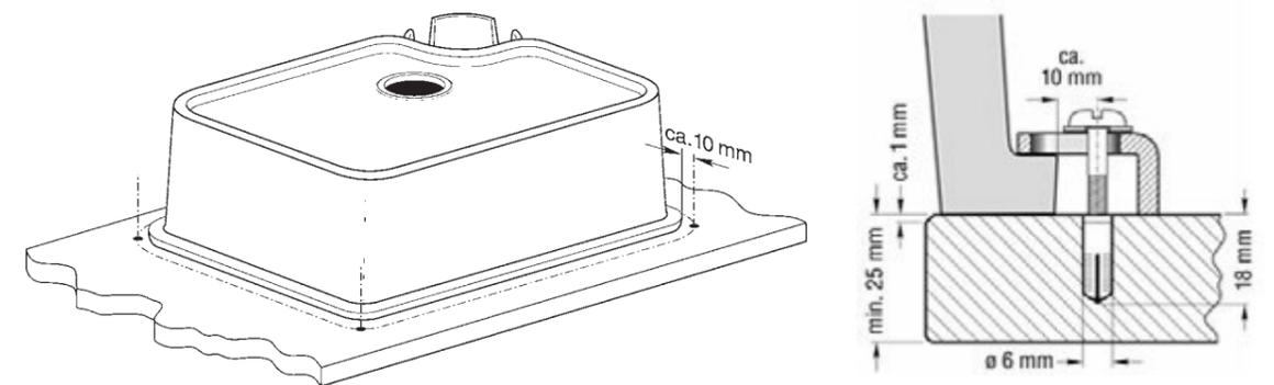
Bei den Ausschnittmaßen sind die keramischen Toleranzen und ein Sicherheitsabstand mit berücksichtigt. Daher kann in verschiedenen Fällen die Abdeckplatte bis zu 11 mm über den Beckenrand ragen.
