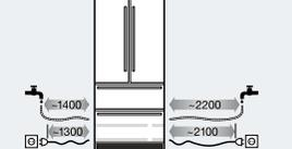
Inklusive 3m Panzerflexschlauch für Festwasseranschluss 3/4"
