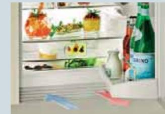
Die Lüftung in den unterbaufähigen Kühlschränken von Liebherr arbeitet nach dem durchdachten Prinzip **Be- und Entlüftung nach vorne**: Die Luft zur Kühlung wird von vorn zugeführt – und tritt auch nach vorn wieder aus – je nach Modell am Sockel oder an der Geräteoberkante. Der Vorteil: Lüftungsschlitze in der Abdeck- und Arbeitsplatte sind nicht mehr erforderlich. Das spart Montageaufwand und bewahrt die ansprechende Oberflächen-Optik des Arbeitsbereichs.
