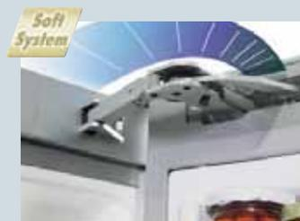
Komfortabel und in der täglichen Anwendung überzeugend ist die **SoftSystem-Schließdämpfung**. Sie dämpft die Bewegung bei der Türschließung ab und gewährleistet selbst bei voller Beladung der Innentür ein besonders sanftes Schließen. Zudem wird die Tür ab einem Öffnungswinkel von ca.  $45^{\circ}$  automatisch geschlossen.
