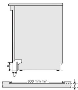
Anpassung an Nischenhöhe min. 82,0–88,0 cm durch Verstellfüße. Leichtes Einschieben des Gerätes in die Nische durch abgerundete Füße. Durch mitgelieferte Montageschablone leichtes Anzeichnen der Markierungen für die Befestigungsschrauben an der serienfertigen Möbeltür.
