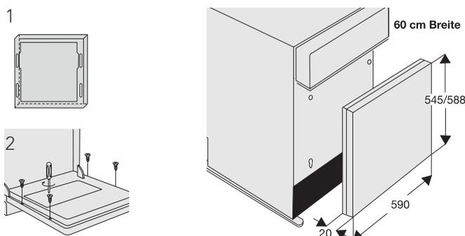
Stufenlose Anpassung an die unterschiedlichen Küchenmöbel-Sockelhöhen durch verstellbare Ausgleichsblendenstücke, die allen integrierbaren Unterbau-Geschirrspülern 60 cm beiliegen.
